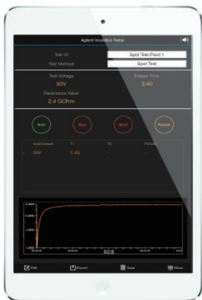
图 2. 使用是德科技绝缘电阻表应用执行远程测试
