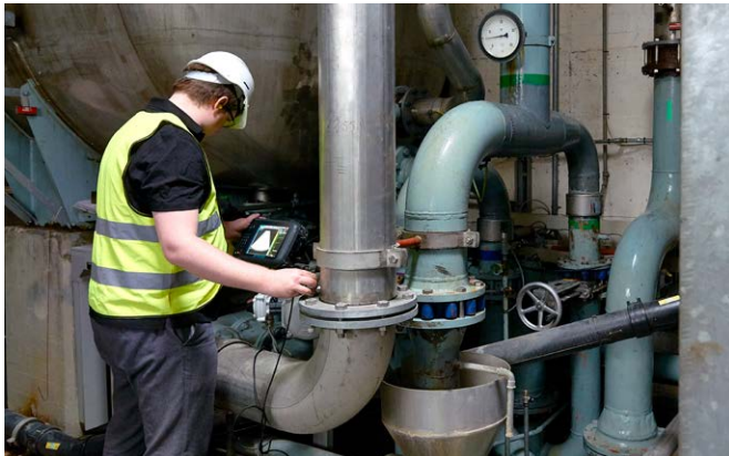
使用 Proceq Flaw Detector 100 进行工业管道检测
