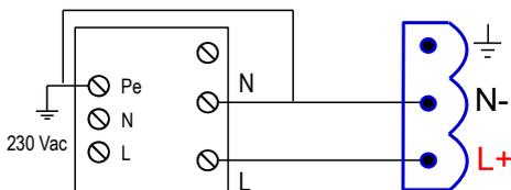
> 电源供应 230 Vdc 接线方式:
