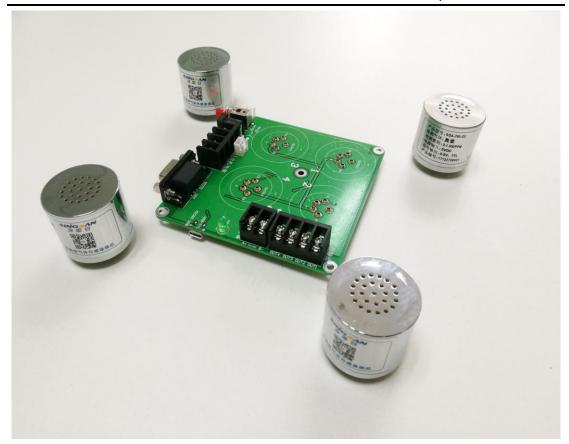
因大气中的气体浓度是非常低的, 所以需要空气质量监测仪的高分辨率。分辨大气中的气体 浓度。且需要稳定的输出监测数据。深国安空气质量监测仪可以1分钟出1组监测数据,数 据可以通过无线传输方式传输到配套的软件中进行存储、预览、打印等等。
