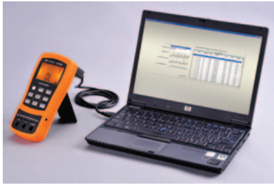
图 1. 将 U1701B 连接至 PC 后，即可自动记录连续读数
