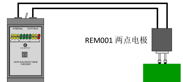
(4) 两点电极测试示意图
